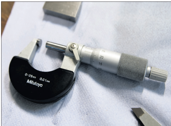
En mikrometerskrue bruges hele tiden hos CNC Products i det daglige præcisionsarbejde. Den kan måle en hundrededel af en millimeter. FOTO: SØREN E. ALWAN.
